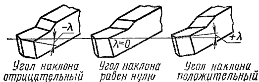
Рис. 4. Угол наклона главной режущей кромки
